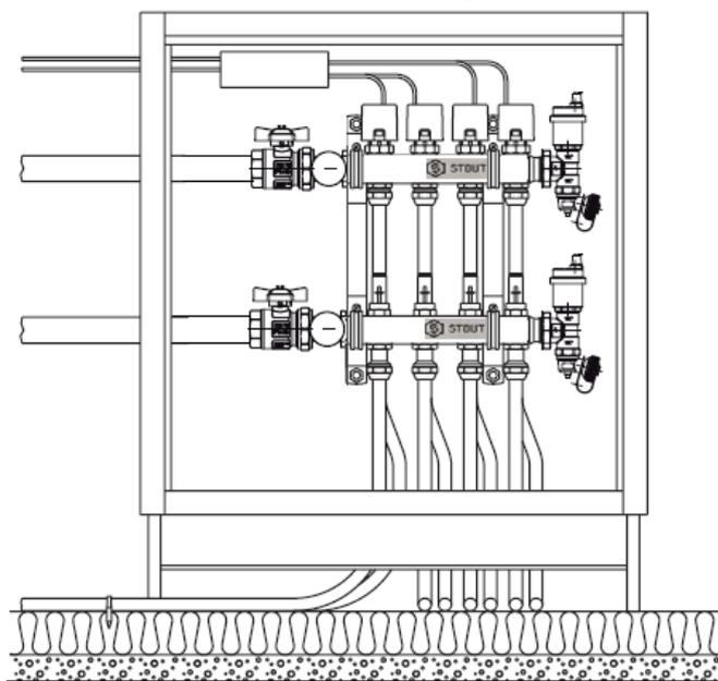
**6.1 Принципиальная схем применения распределительных коллекторов системы отопления:**
